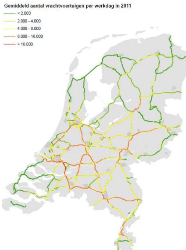
Figuur 1: Intensiteiten van het vrachtverkeer op het hoofdwegennet -2011
